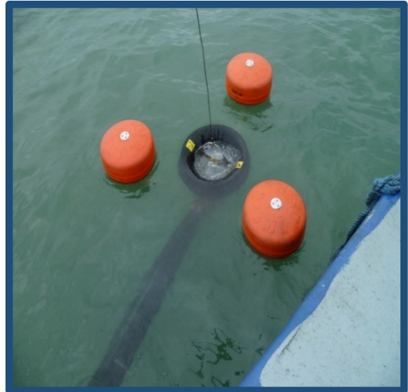
Implantación de equipo skimmer en el área marina contaminada
