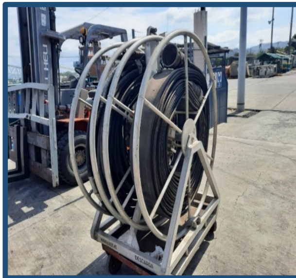
Alistamiento del reel de manguera en complemento a la operación con el equipo skimmer
